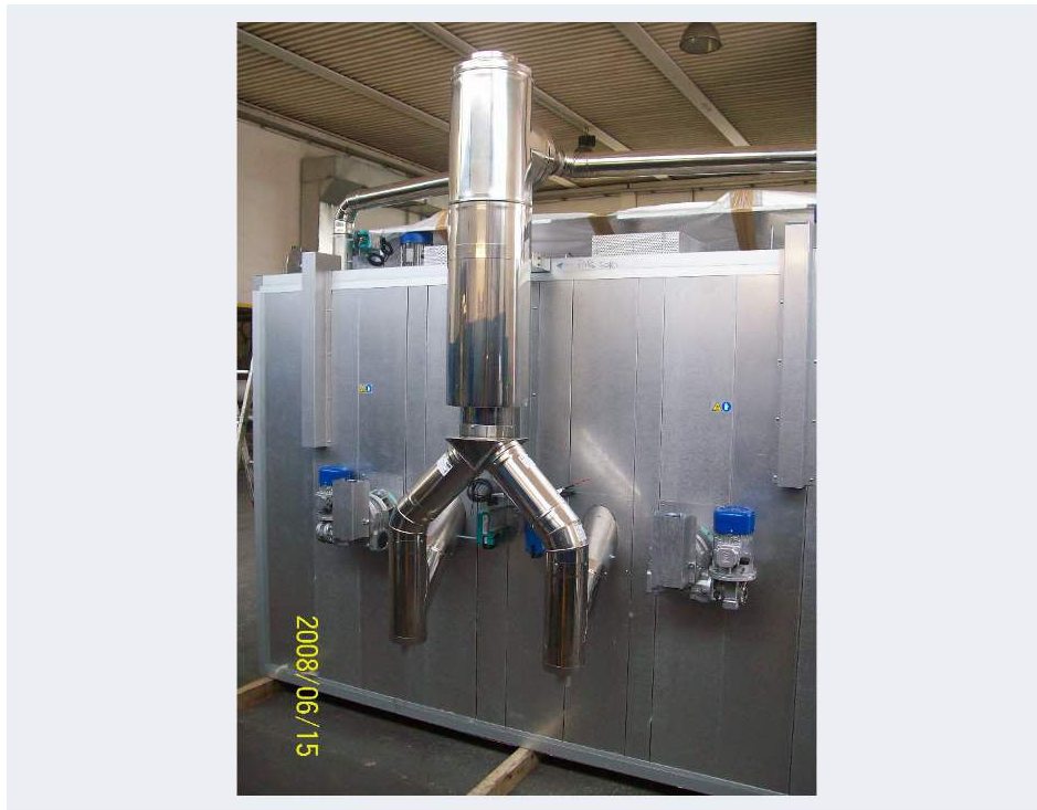
Scambiatore di calore
